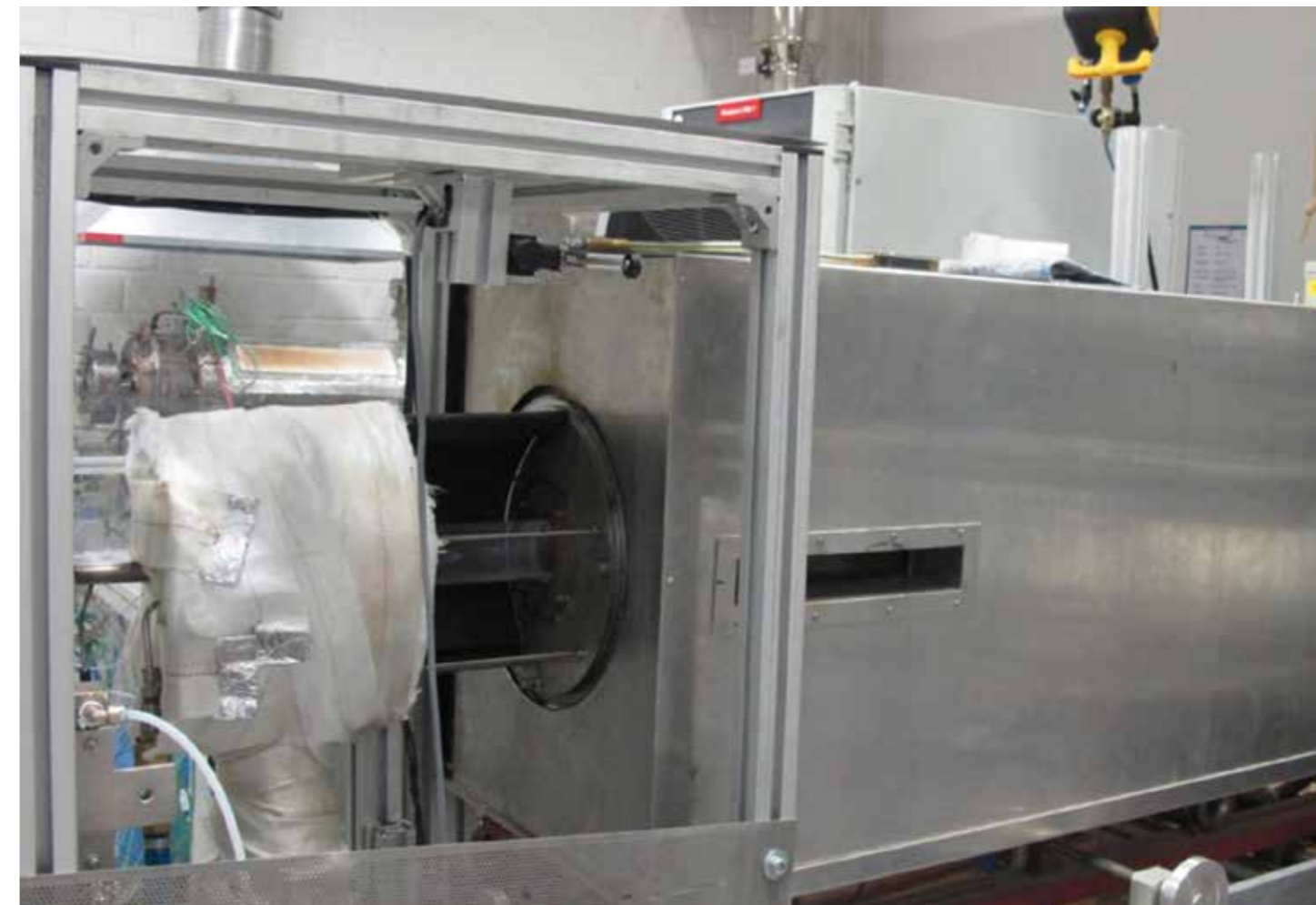
Prüfstand für die Brennerentwicklung zur MTT Mikro-KWK-Anlage.
