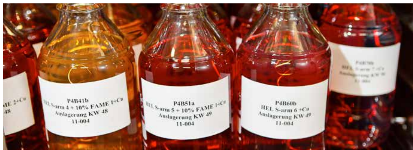
Brennstoffproben mit biogenen Anteilen werden in Langzeittests am OWI auf ihre Wechselwirkungen mit Materialien getestet, die im Heizungsbau zum Einsatz kommen.
