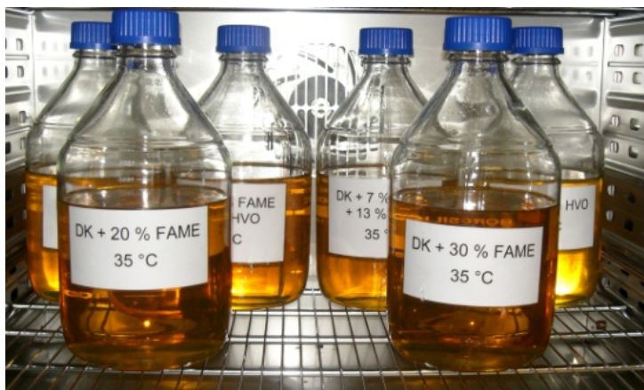
Abbildung 6: Versuchsaufbau der Lagerung im Wärmeschrank.
